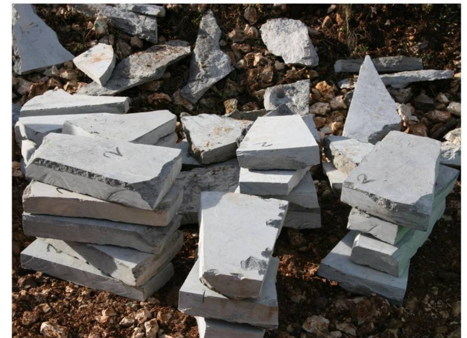
Une partie du stock de dalles taillées, prêt à être posé
